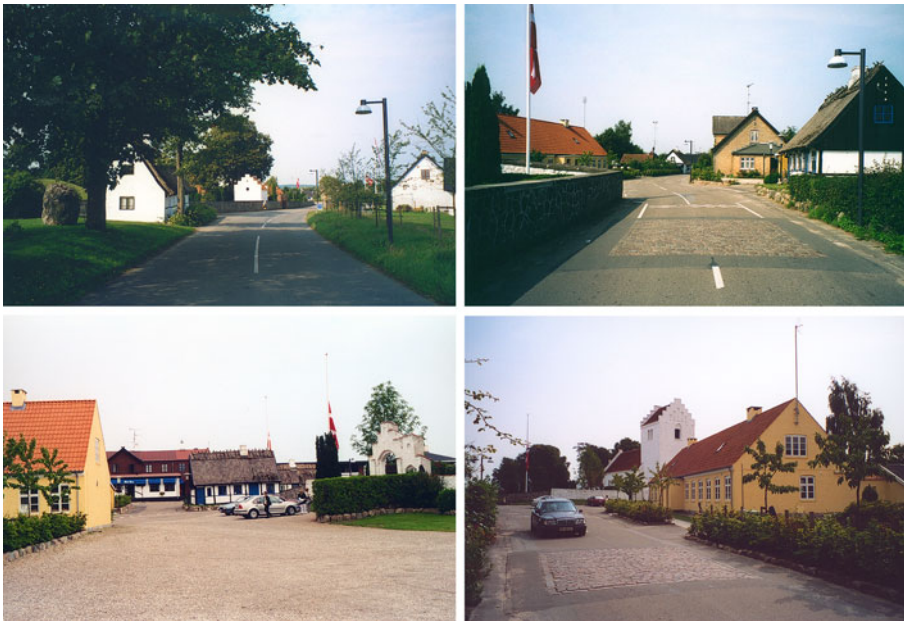
Figur 42. a): Den østlige indkørsel til Bybjerg ad Bygaden er markeret i højre side med nyplantede træer og ny gadebelysning. b): Lidt fremme ad Bygaden er indgangen til "Den kulturelle plads" markeret med brostensbelægning i niveau med asfalten samt med et nyt stengærde i højre side. c): "Den kulturelle plads" set fra den nyanlagte parkeringsplads mellem skolen og kirken, med skolen til venstre, kirken til højre og kroen i baggrunden af billedet. d): Udkørslen fra pladsen er også markeret med brostensbelægning. Til højre i billedet ses kirken og skolen samt nyplantede træer og hække.
